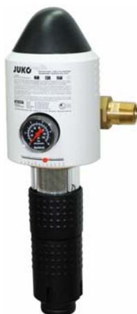
Αυτοκαθαριζόμενο φίλτρο νερού, θερμοκρασίας λειτουργίας έως 30 °C με μηχανισμό αναστροφής της ροής, μειωτή πίεσεως ρυθμιζόμενο από 1,5 έως 6 bar, μανόμετρο ένδειξης της πίεσης εξαγωγής και πιστοποίηση για πόσιμο νερό βάσει των Γερμανικών κανονισμών DVGW – TUV – DIN 19632. Ιδανικό για δίκτυα με υψηλές πιέσεις όπου και απαιτείται ρύθμιση.
